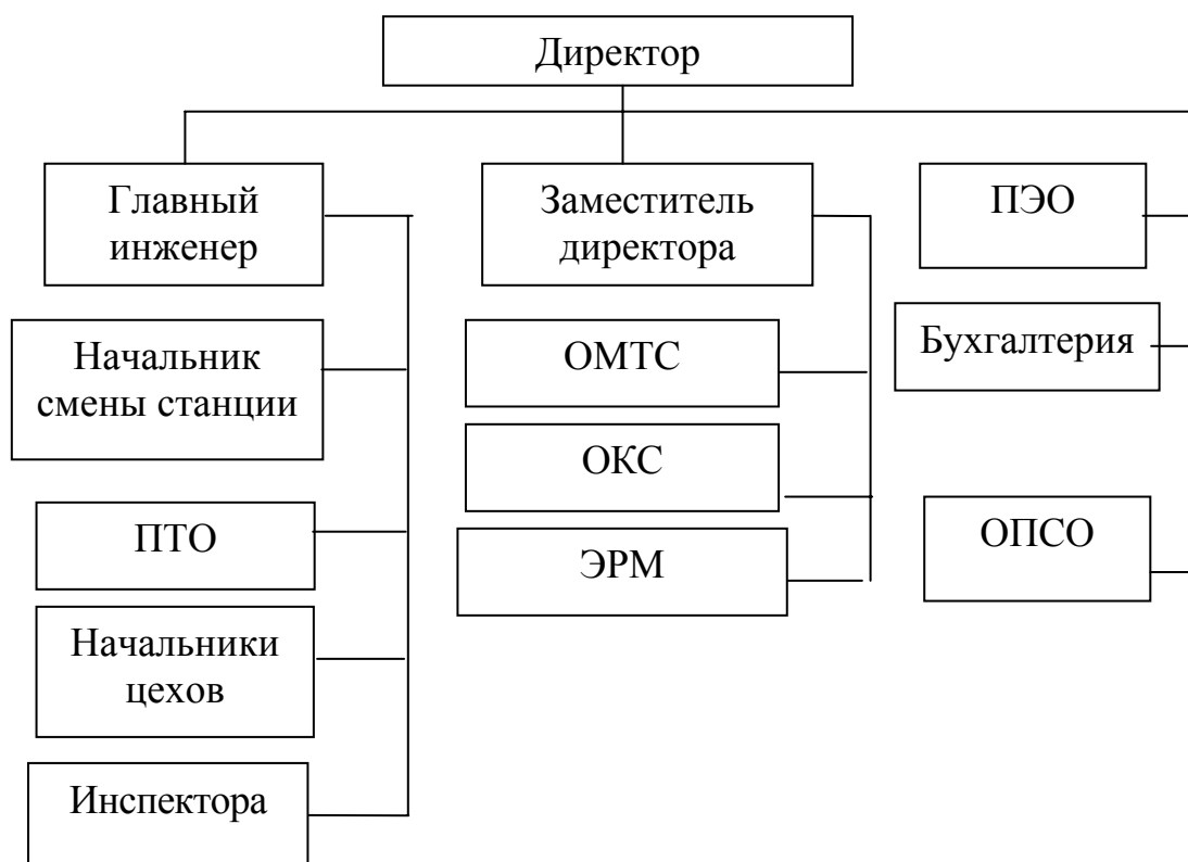
Рис. 11.1. Принципиальная организационная структура тепловой электростанции
